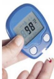
Los biosensores son dispositivos analíticos constituidos de un elemento biológico (enzima, anticuerpo, célula, orgánulo) íntimamente asociado con un transductor físico-químico, que en presencia del analito produce una señal eléctrica que es proporcional a la cantidad presente del mismo. Presentan un enorme potencial para la detección de numerosos analitos tanto en el ámbito del análisis clínico, industria alimenticia o medioambiental.
